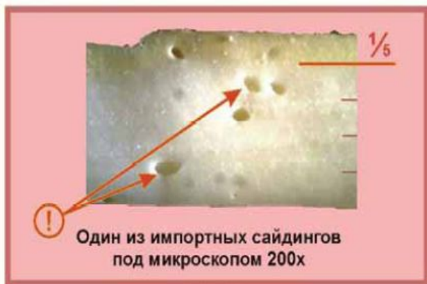
Пример 2. Один из российских сайдингов под микроскопом 200х.
