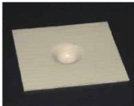
Фото 4. Результат теста ASTM для сайдинга Дёке при превышении ударных усилий на 50%.
