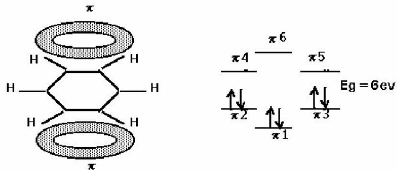
Метод ЛКАО дает 3 связывающих -орбитали (основных уровней) и 3 разрыхляющих орбитали. Связывающие орбитали по принципу Паули заполнены электронами с противоположными спинами. Зазор между ними равный ширине запрещенной зоны или двойному интегралу перекрытия  $-2t$  составляет 6 эВ.
