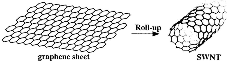
Нанотрубки- свернутые спиралью слои графита Стенки- гексагены, Шапочки- пентагоны и гексагены. Очень прочные (в электронном микроскопе можно видеть термические колебания нанотрубок и из зависимости амплитуды колебаний от  $T$  определить модуль Юнга  $=10^4$ ГП, сталь -200ГП). Трубки характеризуются индексами  $m, n$  -координаты линии, перпендикулярно которой закручивается НТ. Диаметр НТ=  $0,08(m^2+mn+n^2)$  нм Если  $n-m=3p(p=0,1,2\dots)$ , трубка -металлическая, остальные полупроводниковые
