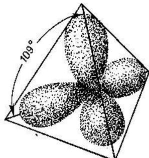
Класс соединений, в которых С выступает в  $2sp^3$  гибридизованном состоянии называется **алканы ( $\text{C}_n \text{H}_{2n+2}$ )**, к ним относятся **метан ( $\text{CH}_4$ )**, пропан, полиэтилен, а также алмаз
