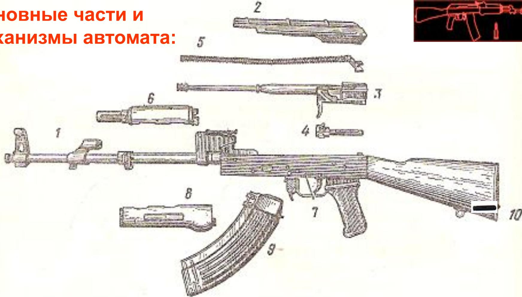
1-ствол со ствольной коробкой, с прицельным приспособлением и прикладом, 2-крышка ствольной коробки, 3-затворная рама, 4-затвор, 5-возвратный механизм, 6-газовая трубка со ствольной накладкой, 7-ударно-спусковой механизм, 8-цевья, 9-магазин, 10-пенал с принадлежностями
