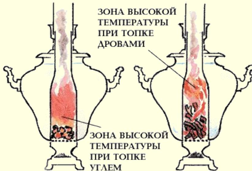
Лучшее топливо для самовара - древесный уголь. Количество сгоревшего углерода, а следовательно, и выделившегося тепла пропорционально расходу кислорода. Это дает возможность регулировать процесс топки подачей воздуха. Горение не должно быть чересчур интенсивным, иначе возрастают теплопотери.
