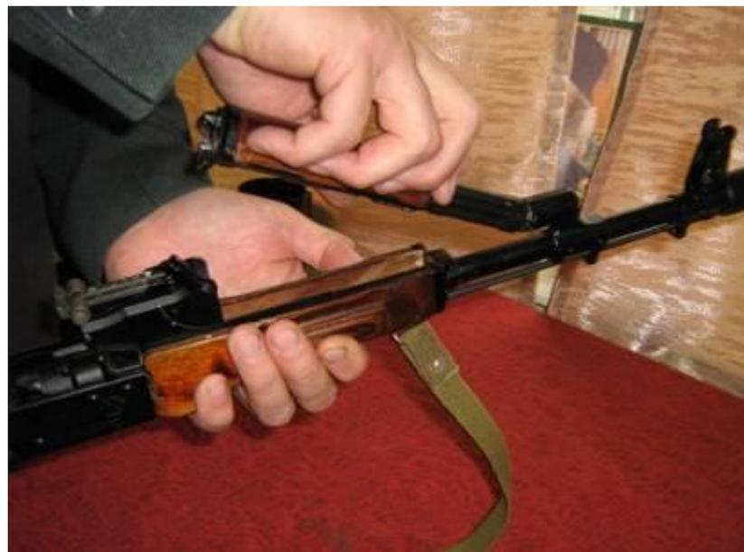
На прицеле с правой стороны поднять флажок замыкателя вертикально вверх и поднять деталь кверху.
