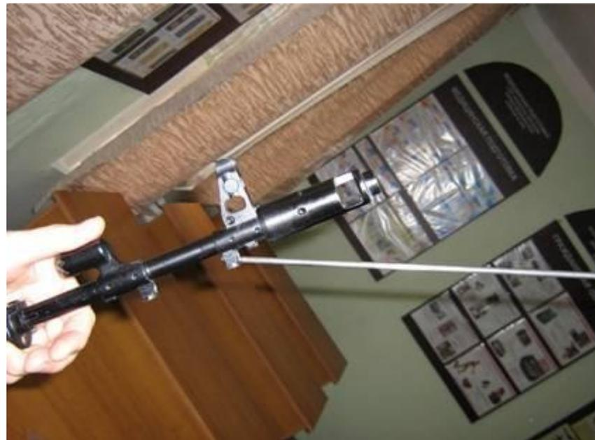
Оттянуть конец шомпола от ствола так, чтобы его головка вышла из-под упора на основании мушки
