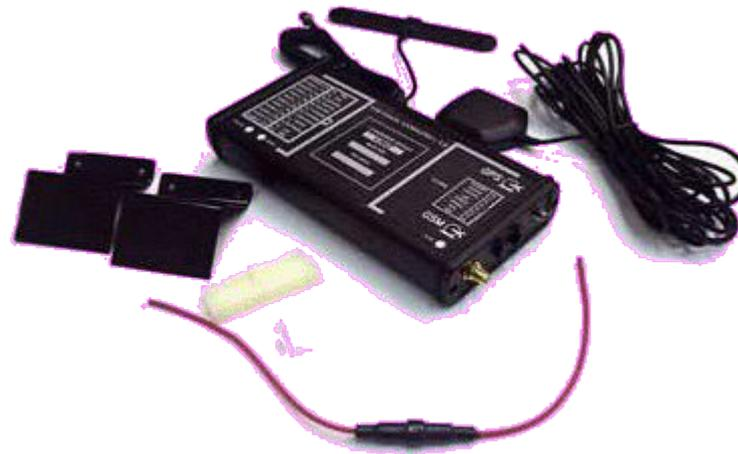
Непрерывное определение местоположения и параметров движения автомобиля в реальном времени осуществляется с использованием системы спутниковой навигации «NavStar GPS».
