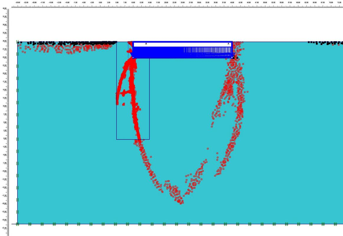
PLAXIS. Пластические зоны от равномерной нагрузки, равной расчетному сопротивлению грунта основания
