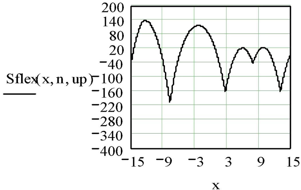
Расчет 13. **2D.** Искажение эпюры изгибающих моментов в фундаменте при незначительной глубине прорезки - 0.1 м. При нулевой прорезке система разрешающих уравнений коллапсирует
