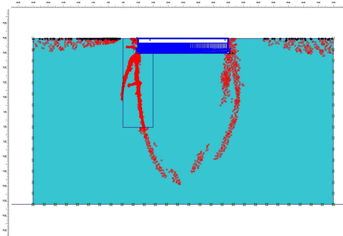
PLAXIS. Пластические зоны от равномерной нагрузки, равной  $R$  - расчетному сопротивлению грунта основания
