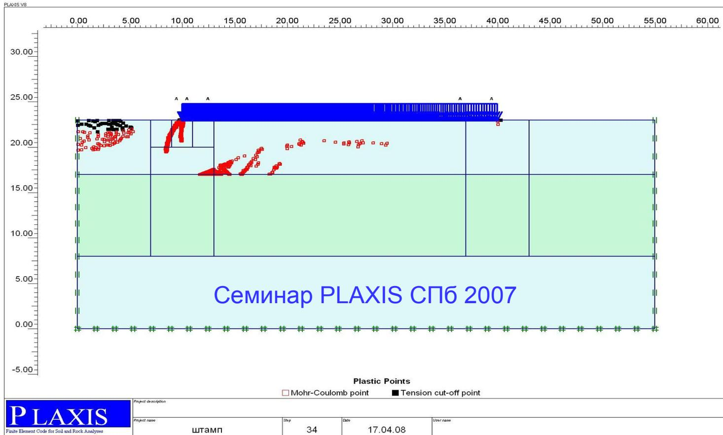
Расчет 11. **2D**. Жесткий фундамент шириной 30 м,  $q=5$  кПа, Грунт:  $E=30$  МПа,  $c=5$  кПа,  $\phi=33^\circ$ . Даже при малой нагрузке возникают пластические зоны, форма которых зависит от измельчения сетки
