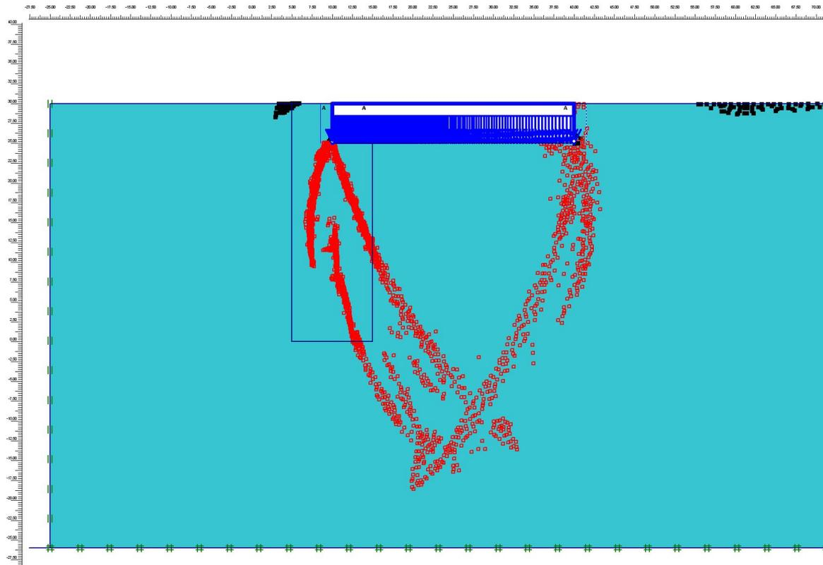
PLAXIS. Смыкание пластических зон под равномерной нагрузкой, равной расчетному сопротивлению грунта основания  $R_0$ .
