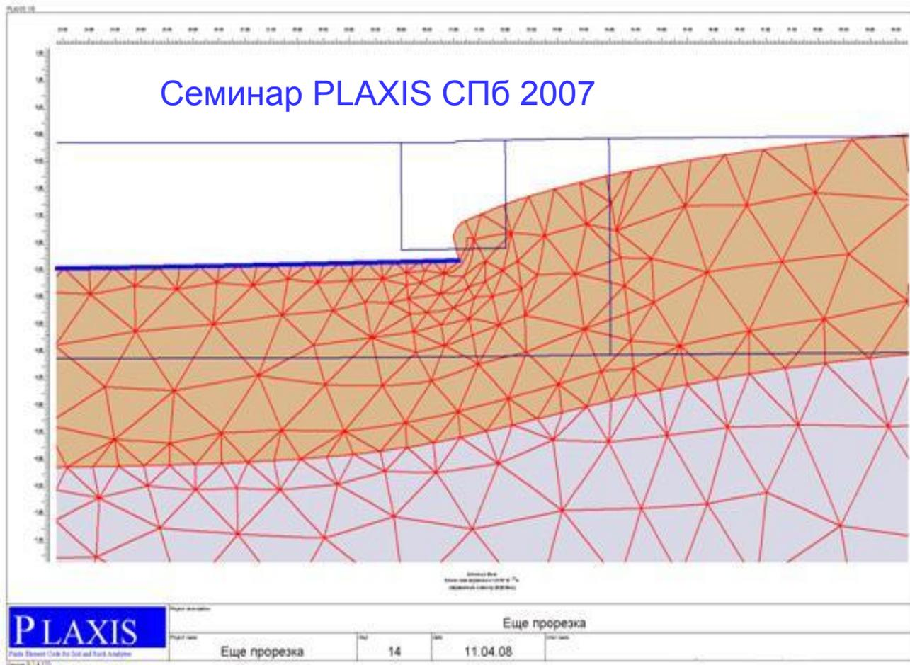
**Скачок перемещений поверхности грунта под краем фундамента**
