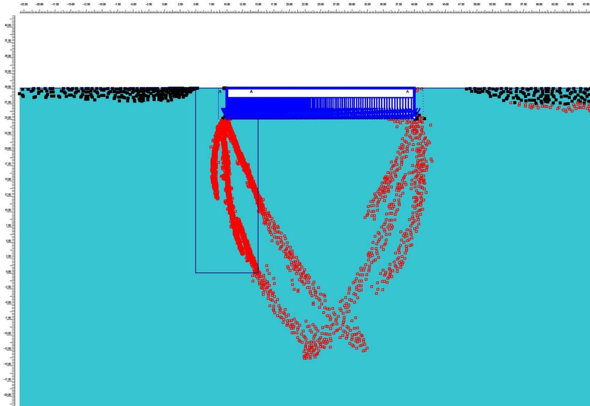
PLAXIS. Пластические зоны от равномерной нагрузки, равной расчетному сопротивлению грунта основания. Под левым краем фундамента мелкая сетка КЭ
