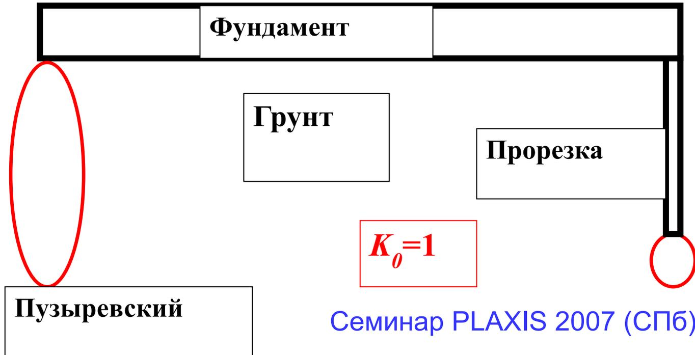
Замена «пластической» зоны Пузыревского на прорезку с точечной пластической зоной на нижнем конце.
