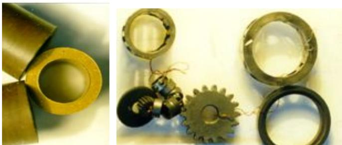
Детали узлов трения из композиционных материалов на основе термостойких связующих
