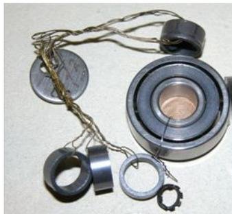
Сепараторы уникальных шарикоподшипников приборов
