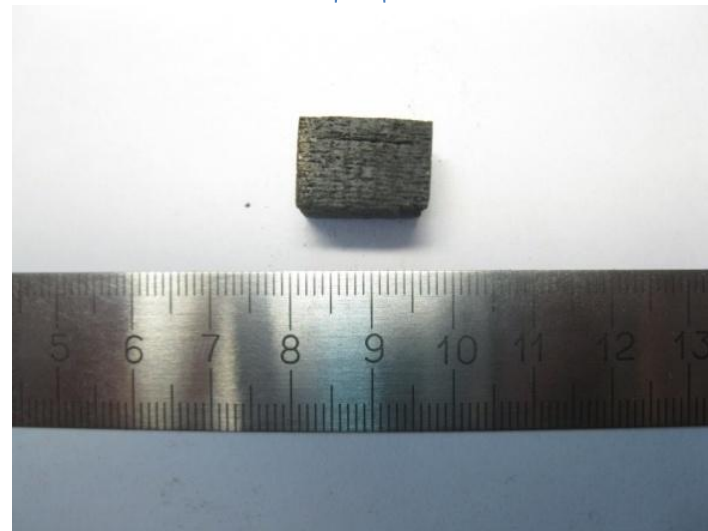
После прогрева при t=300-400^{\circ}\text{C} в аргоне
