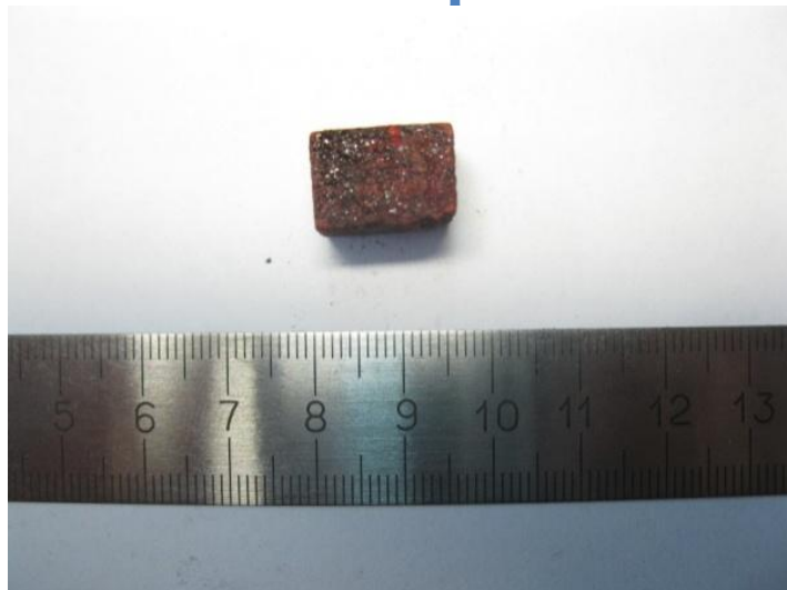
Результат пропитки титаном химическим методом
