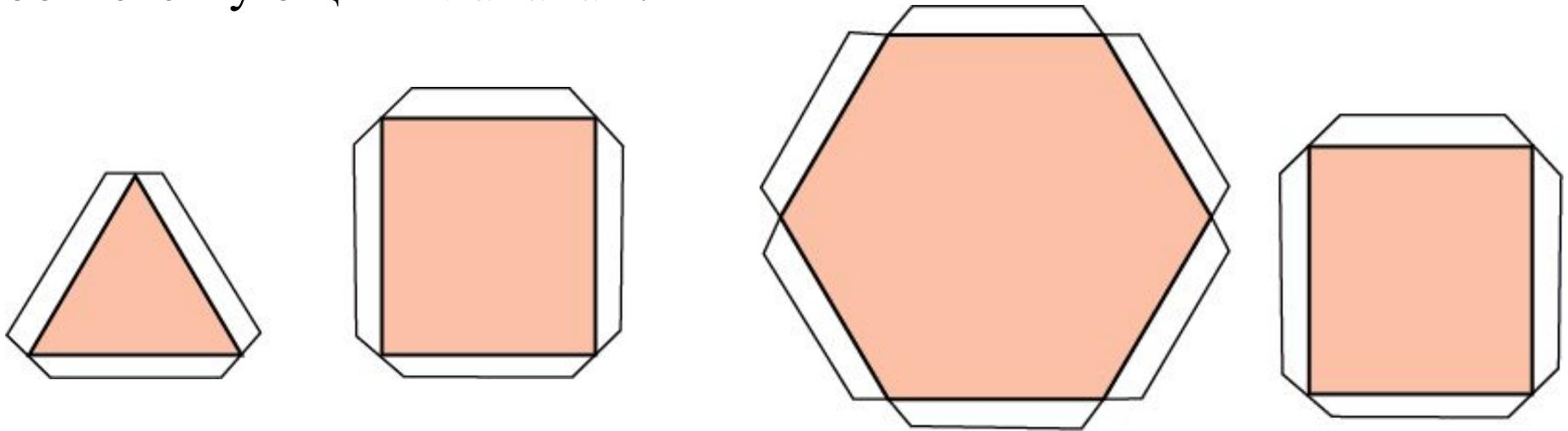
Для изготовления модели правильной шестиугольной призмы нужно вырезать два равных правильных шестиугольника с клапанами и шесть равных прямоугольников с клапанами, одна сторона которых равна стороне шестиугольника, как показано на рисунке, и склеить их по соответствующим клапанам.
