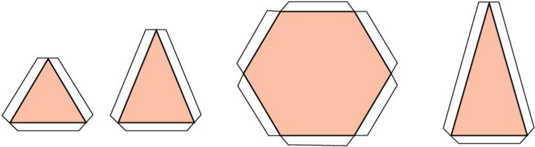
Для изготовления модели правильной шестиугольной пирамиды нужно вырезать правильный шестиугольник с клапанами и шесть равных равнобедренных треугольника с клапанами, одна сторона которых равна стороне правильного шестиугольника, как показано на рисунке, и склеить их по соответствующим клапанам.
