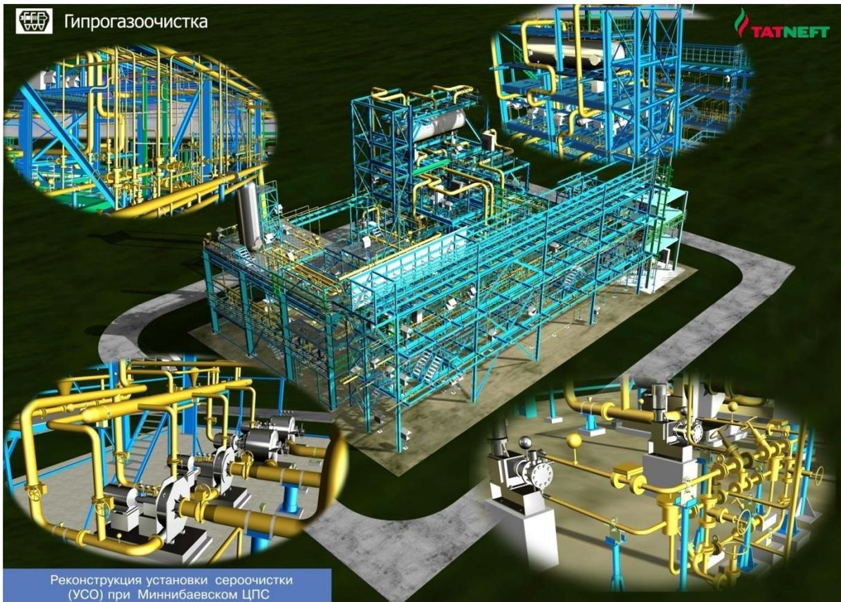
**Производство элементарной серы по окислительному методу Клауса с подачей в конденсаторы на охлаждение технологического газа раствора ТЭГ. Блок грануляции жидкой серы оснащен установкой грануляции фирмы SANDVIK.**
