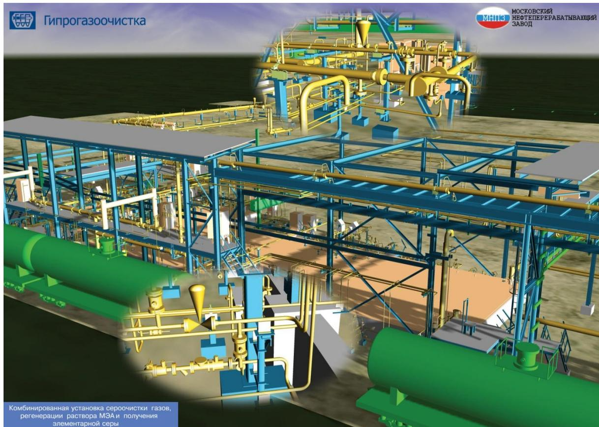
**Реконструкция блоков по производству серы и эстакады налива жидкой серы в железнодорожные цистерны в составе комбинированной установки сероочистки газов**
