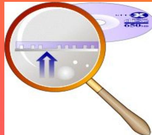
Информация на лазерный диск записывается в виде микроскопических углублений на его поверхности. Яркость отражения лазерного луча уменьшается, когда он попадает в углубления. Таким образом, удается хранить и считывать информацию: углубление соответствует числу 0, а отсутствие углубления — числу 1.
