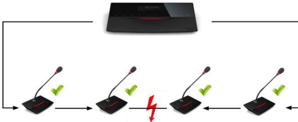
Дискуссионные пульты могут подсоединяться в цепочку или кольцо. Соединенный по цепи в контур, запатентованный механизм резервирования гарантирует, что система продолжит работать, даже если вдруг кабель оборвется или по каким-то причинам будет рассоединен.
