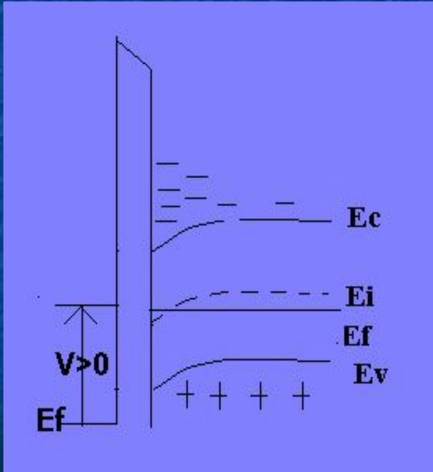
При достаточно большом  $V_g$  (большем чем пороговое напряжение) приповерхностный слой сильно обогащается неосновными носителями и заряда, между истоком и стоком образуется индуцированный (наведенный) канал заряд, по которому может протекать ток. Транзисторы с индуцированным каналом работают только в режиме обогащения.
