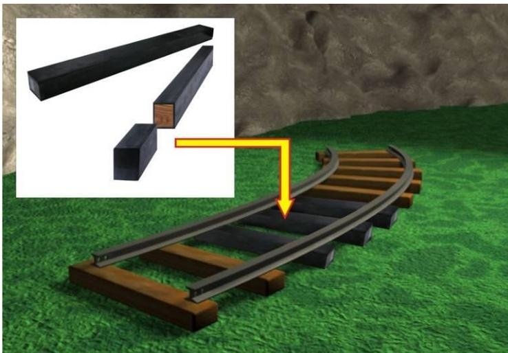
Новая конструкция шпалы представляет собой композицию состоящую из традиционной деревянной шпалы с покрытием на основе смеси полиуретана с резиновой крошкой, полностью изолирующим поверхность древесины от воздействия окружающей среды при эксплуатации.
