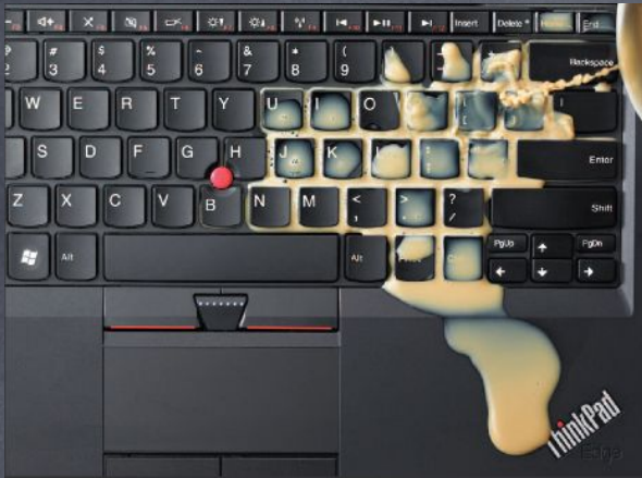
Защита клавиатуры от пролитой жидкости
