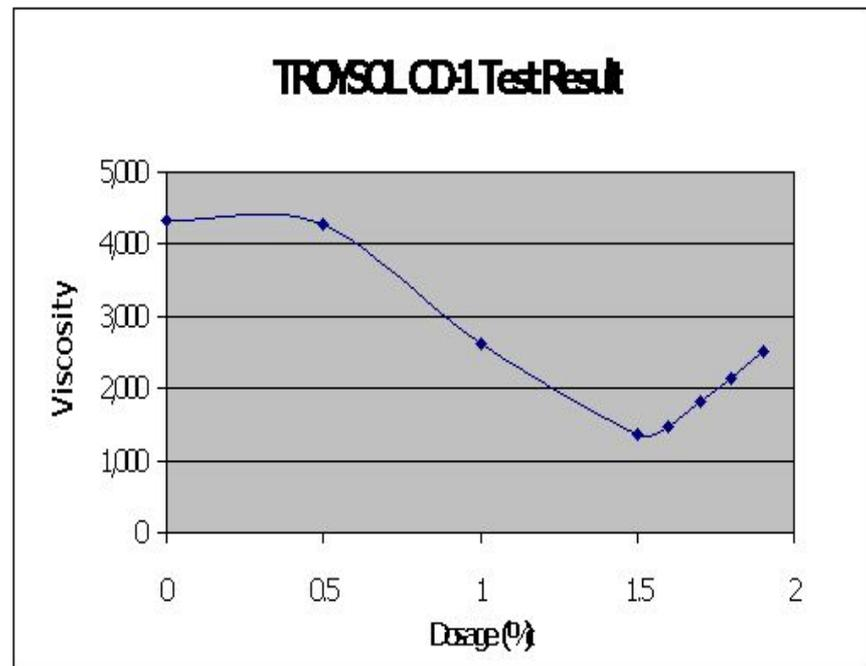
\*Вязкость измерялась по Brookfield, шпindelь #3 скорость 12 об/мин
