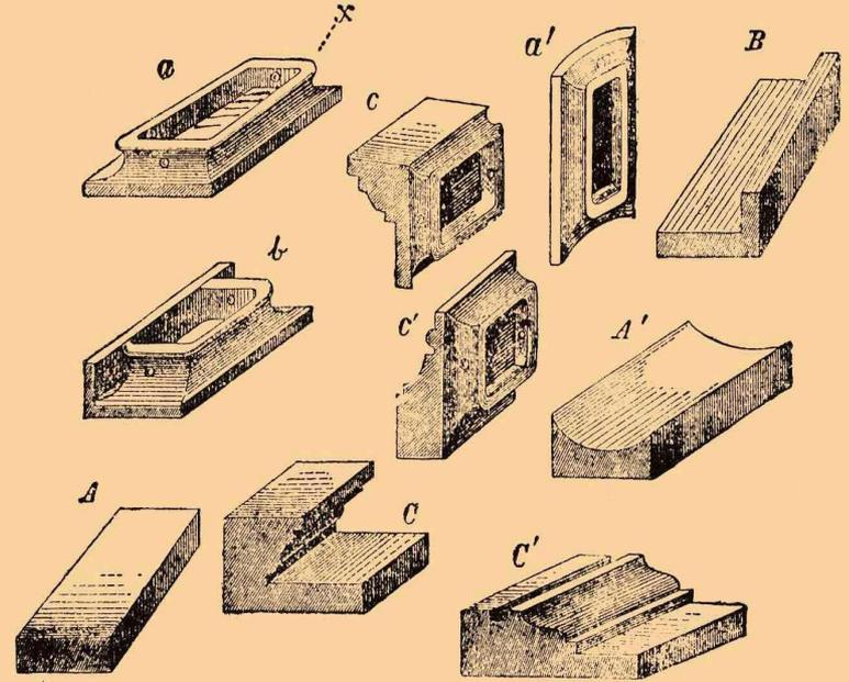
а, а', б, б', с, с'—печные изразцы для разных частей печи. А, А', В, С, С'—формы или коладки, при помощи которыхъ изготовляются изразцы.
