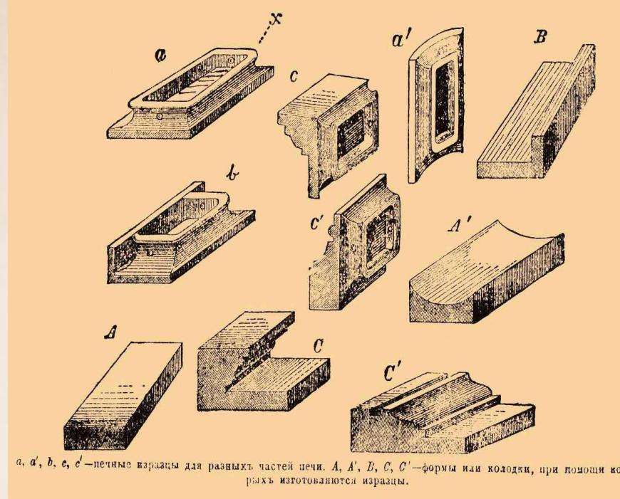
*a, a', b, c, c'*—печные изразцы для разных частей печи. *A, A', B, C, C'*—формы или колодки, при помощи которых изготавливаются изразцы.
