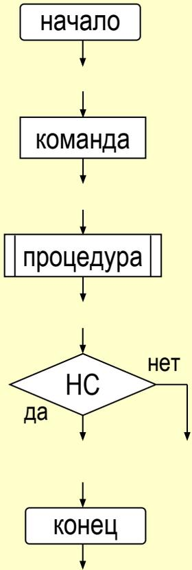
**Блок-схема – графическое изображение алгоритма.**
