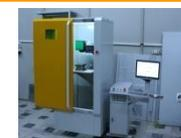
**Серия МЛП2 (МЛП21, МЛП2, МЛП23, МЛП24, МЛП25)** Топологические размеры 0.1-10 мкм. Точность 0.5- 1мкм. Поля обработки до 1000 мм
