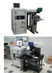
**Серия МЛ3.** Мощность до 500Вт. Точность 50 - 100мкм. Скорость менее 1-2м/мин.
