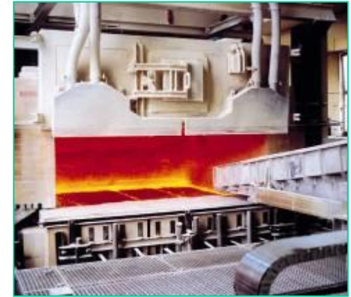
Печь прямой плавки стекла
