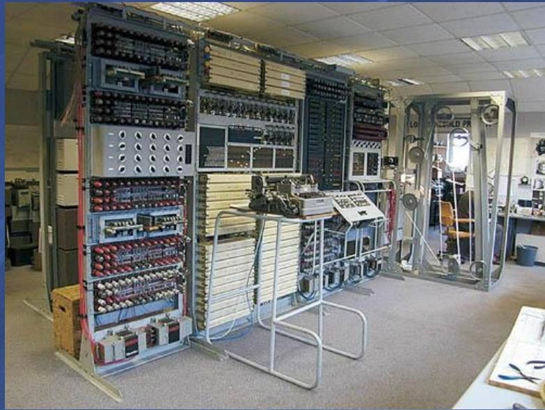
1942-1943 гг. В Англии при участии Алана Тьюринга была создана вычислительная машина "Colossus". В ней было уже 2000 электронных ламп. Машина предназначалась для расшифровки радиограмм германского Вермахта.
