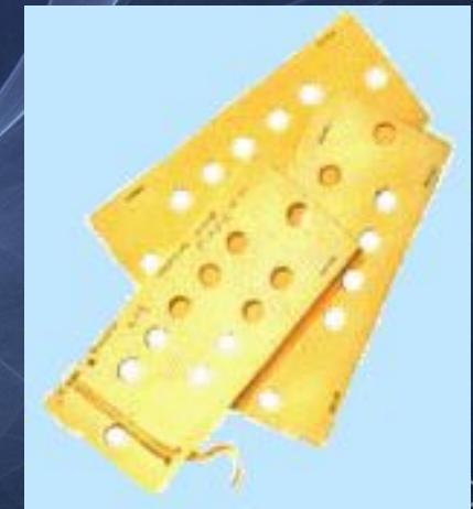
Ввод чисел в машины производился с помощью перфокарт, а программное управление осуществлялось, например в ENIAC, с помощью штекеров и наборных полей. Когда все лампы работали, инженерный персонал мог настроить ENIAC на какую-нибудь задачу, вручную изменив подключение 6 000 проводов.
