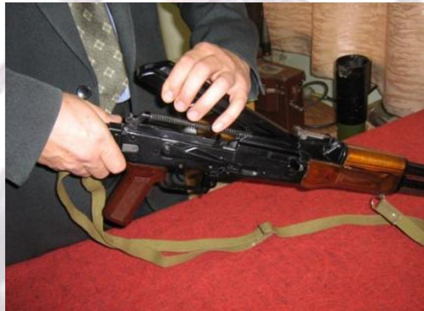
Большим пальцем правой руки нажать на выступ возвратного механизма и поднять крышку ствольной коробки кверху
