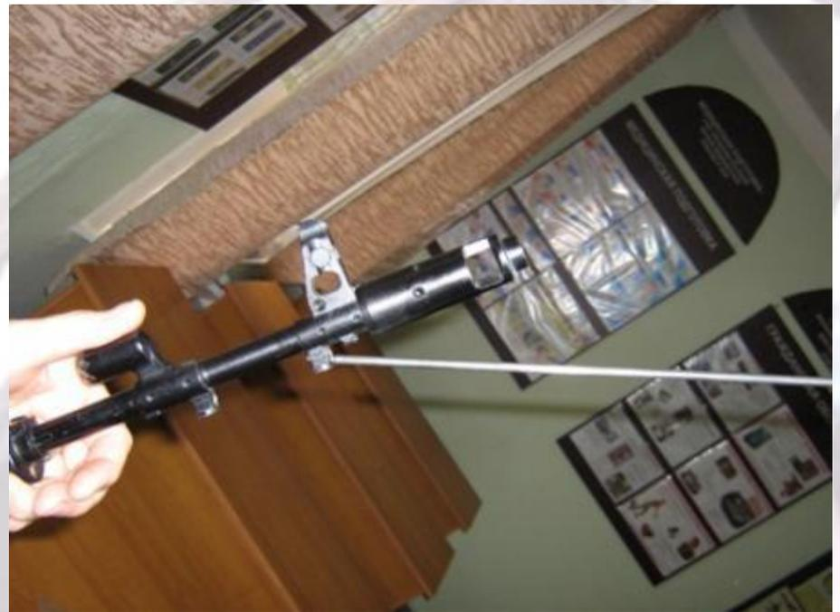
Оттянуть конец шомпола от ствола так, чтобы его головка вышла из-под упора на основании мушки и вынуть шомпол вверх
