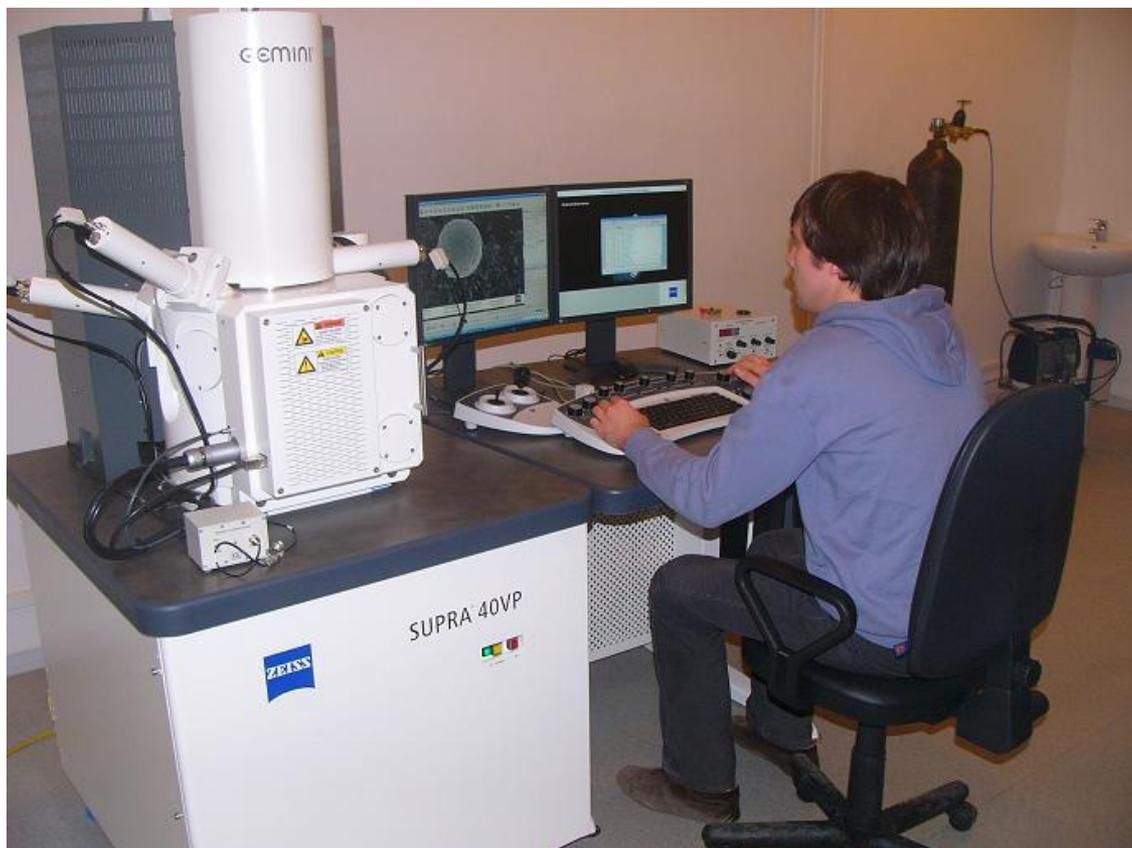
\*Многофункциональный аналитический растровый электронный микроскоп Supra 40 с разрешением 1нм, с системами микроанализа, охлаждения до гелиевых температур, катодолюминесцентной спектроскопии, наноманипулирования
