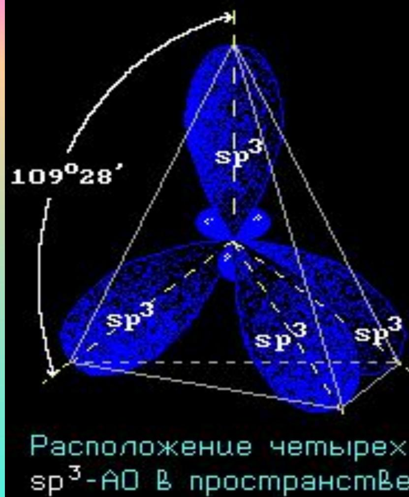
Оси  $sp^3$ -гибридных орбиталей направлены к вершинам правильного тетраэдра. Тетраэдрический угол между ними равен  $109^\circ 28'$ , что соответствует наименьшей энергии отталкивания электронов.
