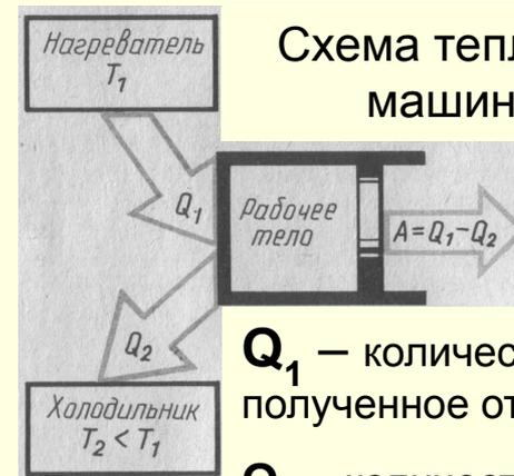
Схема тепловой машины
