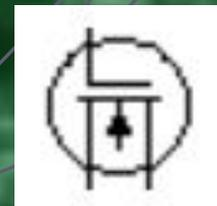
С изолированным затвором обедненного типа с n-каналом (встроенным)
