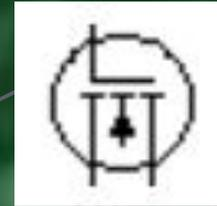
С изолированным затвором обогащенного типа с n-каналом (индуцированным)
