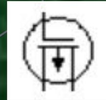
С изолированным затвором обедненного типа с p-каналом (встроенным)
