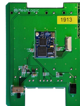
Беспроводной датчик системы мониторинга температуры
