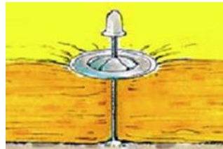
Приварные штифты SP2 и фиксирующие шайбы CL
