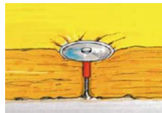
Приварные штифты CDF ISOL (часть шпильки с изоляцией)
