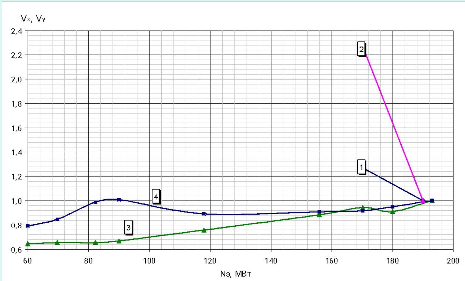
1 и 2 – горизонтальная и вертикальная составляющая виброскорости (без экрана); 3 и 4 - горизонтальная и вертикальная составляющая виброскорости (с экраном)
