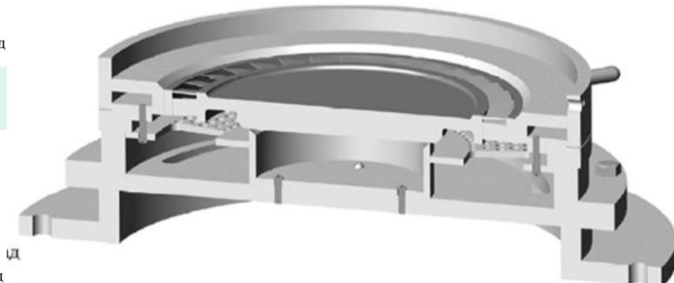
Установлен перфорированный конический экран с канавками и окнами
