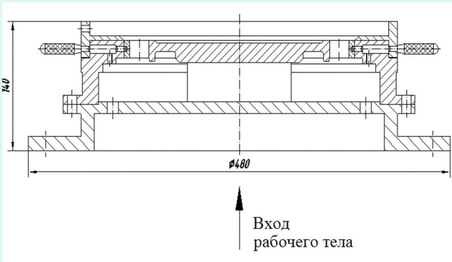
Продольный разрез экспериментальной установки для исследования кольцевых диафрагм
