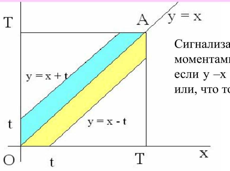
Сигнализатор срабатывает, если разность между моментами поступления сигналов меньше  $t$ , т.е., если  $y - x < t$  при  $y > x$  и  $x - y < t$  при  $x > y$ , или, что то же,
