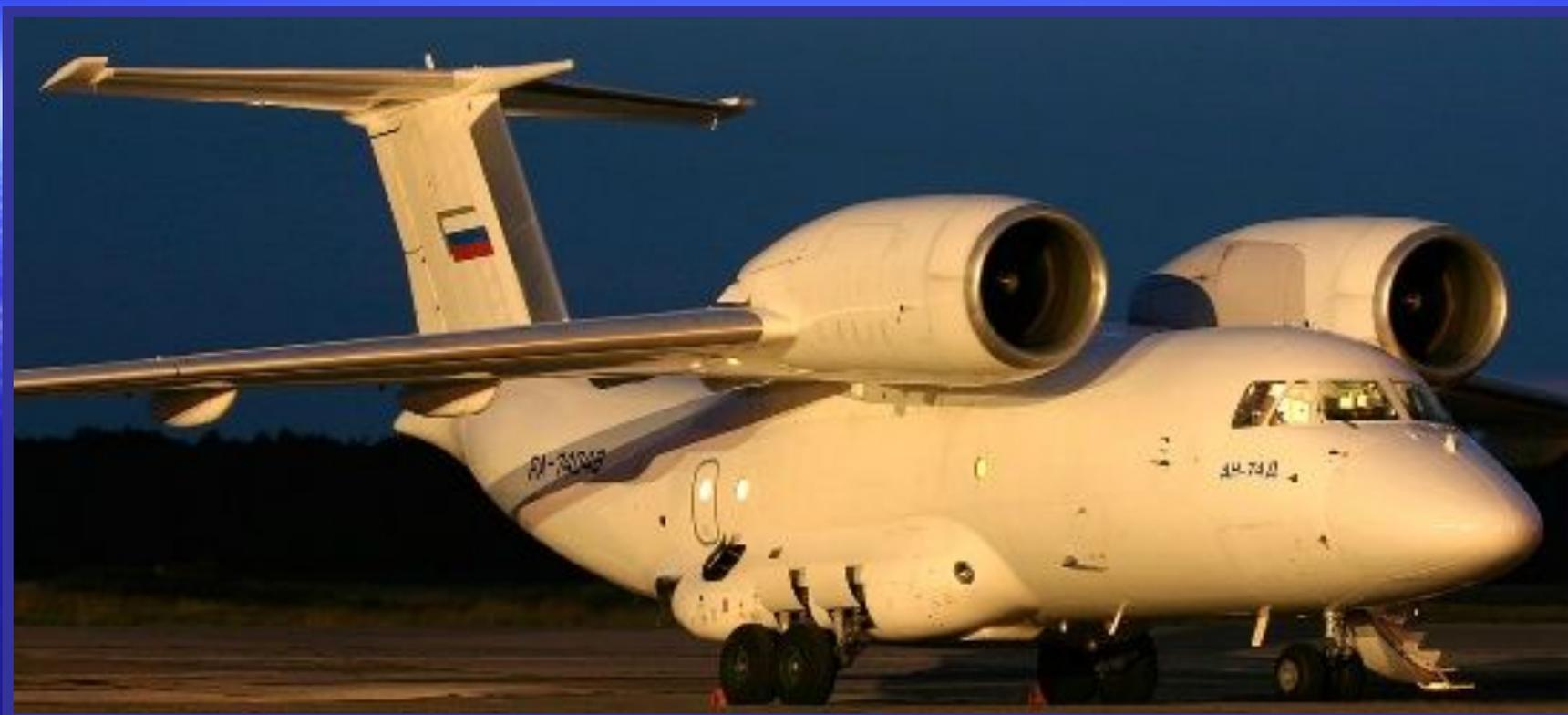
**Высокая тяговооруженность позволяет самолету при отказе одного из двигателей продолжить полет на высоте до 8000 м с максимальной полезной нагрузкой.**
