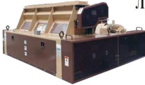
Крошитель Bliss задуман так чтобы быть установлен под охладителями. Реверсивная пакетная подача дает возможность обойти рулоны без их джежения или подстройки. Пакетная подача продвигает продукт прямо к краю рулонов. Реверс подачи - и продукт обходит рулоны без их движения или подстройки.
