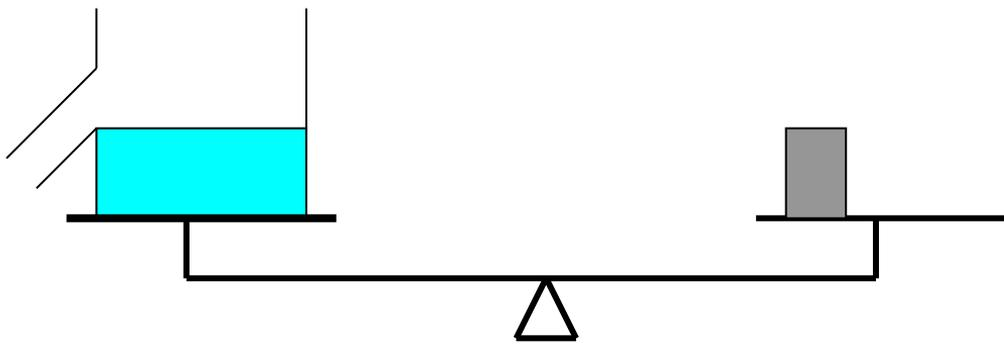
**Вывод 1:** Масса плавающего тела равна массе жидкости вытесненной данным телом.
