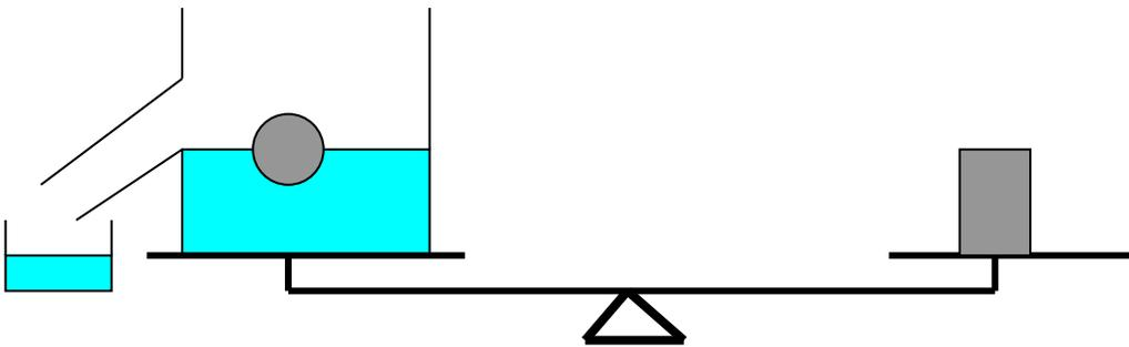
**Вывод 2:** Масса тонущего тела больше массы жидкости вытесненной данным телом.
