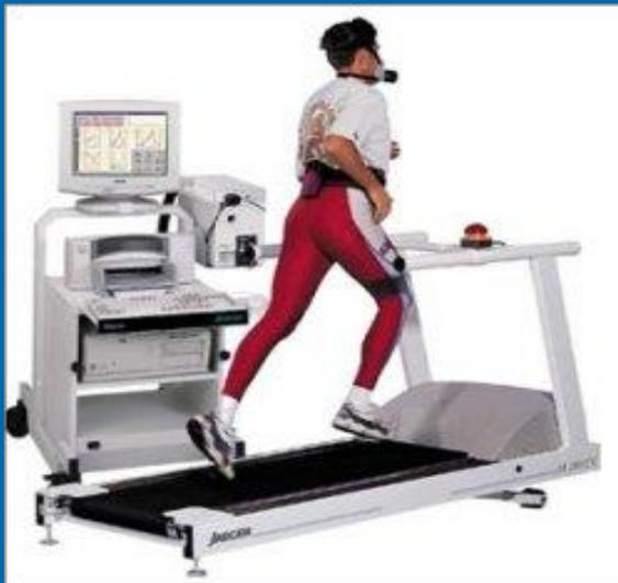
Система для проведения кардиопульмональных исследований с дозированной физической нагрузкой.
