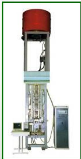
Установка предназначена для вытягивания стеклянных трубок и стержней из расплава стеклоблоков.
