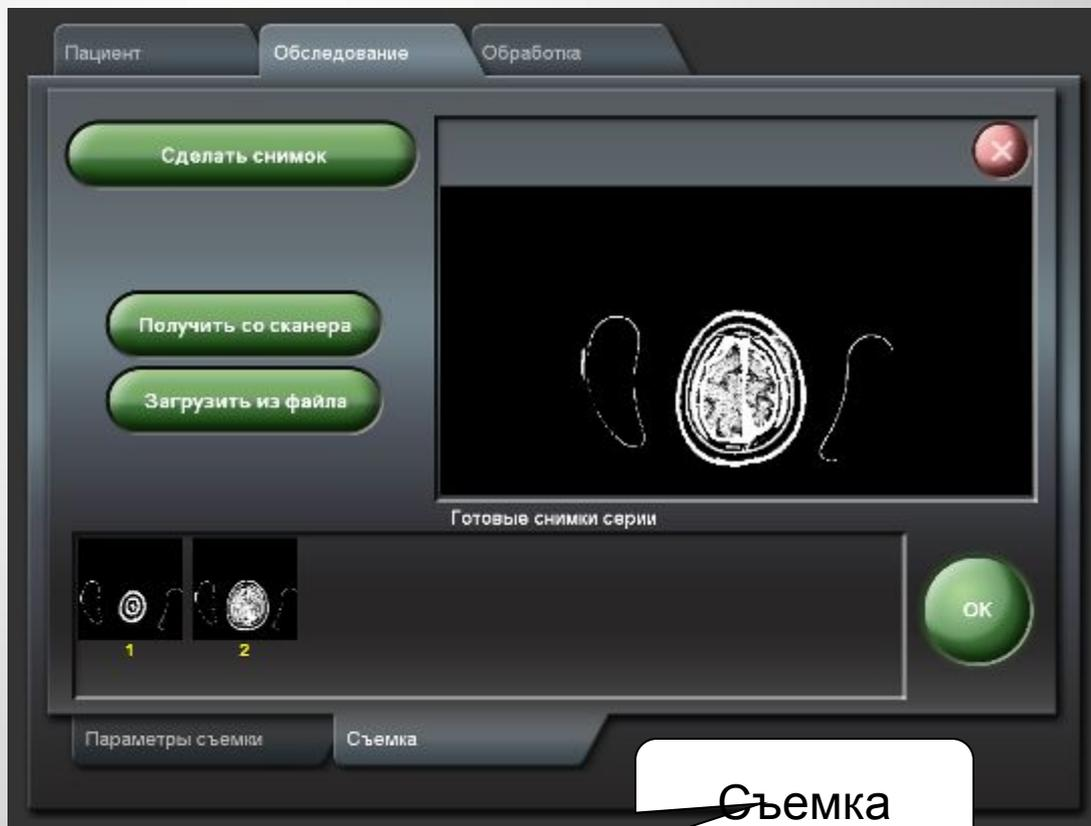
Ввод исходного изображения с разрабатываемого модуля регистратора рентгеновского изображения, со сканера или из дискового файла.
