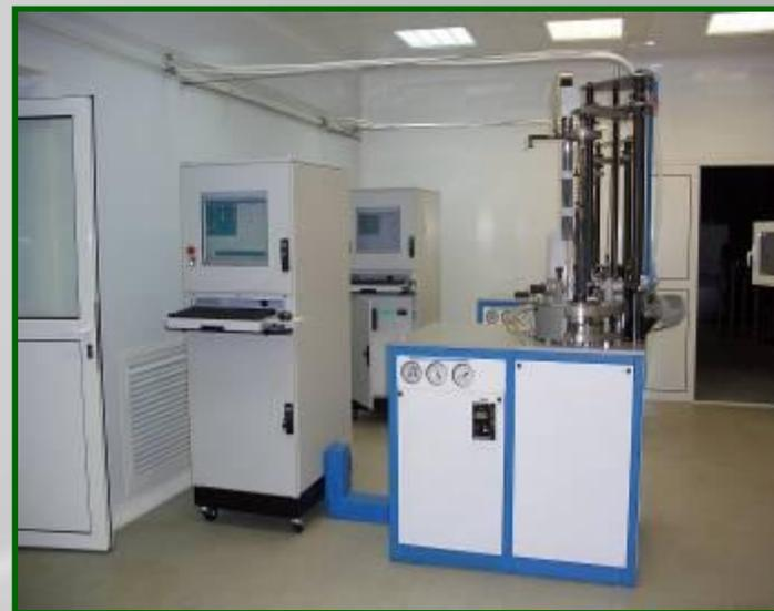
Установка предназначена для спекания многоканальных пластин, которые изготовлены из стеклянных трубок.
