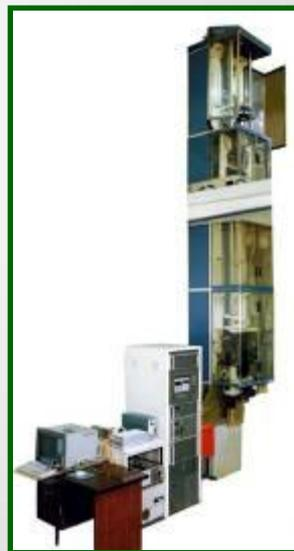
Установка предназначена для изготовления методом перетягивания стеклоизделий с различным профилем поперечного сечения.
