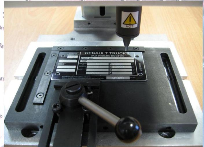
Маркировка производится при помощи ударно-точечной технологии.
