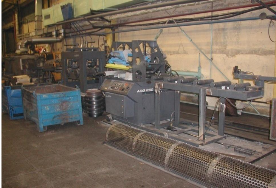
РУП «Цветмет», г. Жодино Технология и специальная линия непрерывного горизонтального литья прутков из латуни
