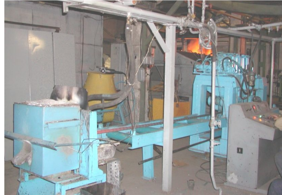
РУП «завод «Могилевлифтмаш» Технология и специальное оборудование для получения из сплавов на основе меди и их отходов непрерывнолитых заготовок электродов
