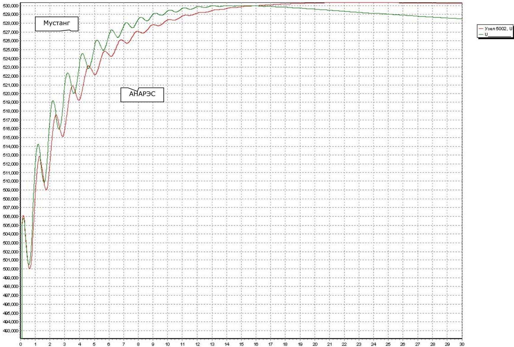
Отключение 500МВт нагрузки в узле 5002. Напряжение узла 5002
