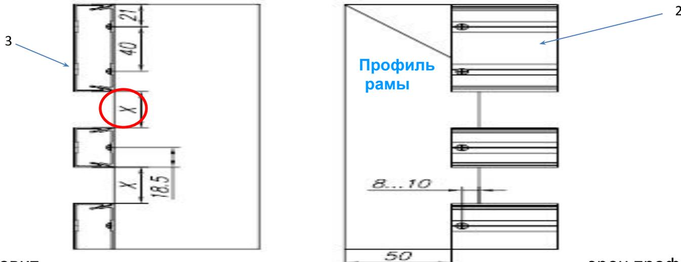
1. Установить верхний профиль запорного механизма вровень с верхним створкой, шпорец профиля устанавливается на расстоянии 50 мм от торца створки. Нижний профиль разреженного заполнения на откатных воротах устанавливается на расстоянии 110 мм от нижнего края шины. На распашных воротах и калитке нижний профиль разреженного заполнения устанавливается вровень с низом створки.
