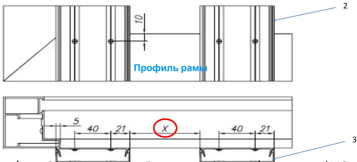
1. Установить профиль 2 на расстоянии 5 мм от стенки профиля рамы (110 мм от низа створки у откатных ворот, у распашных вровень с низом рамы).
