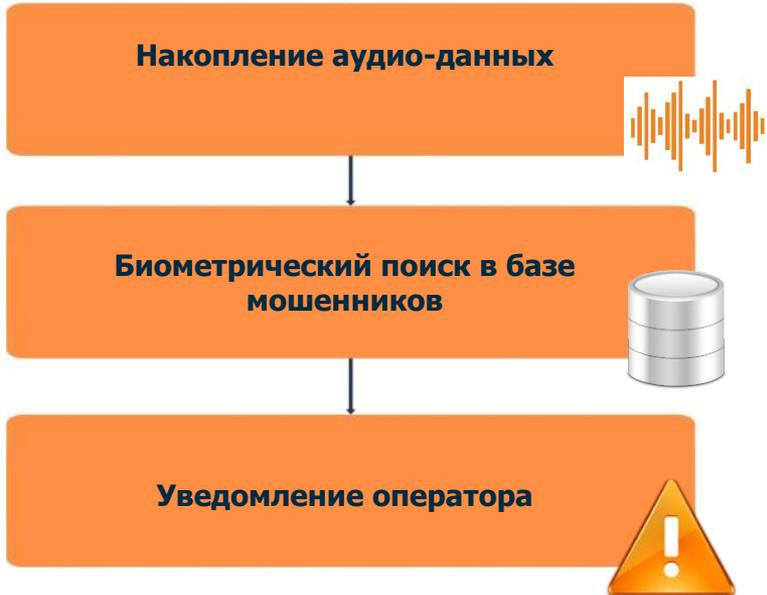
Система сверяет голос звонящего с голосовыми эталонами мошенников и выдаёт результат сверки на окно рабочего стола оператора
