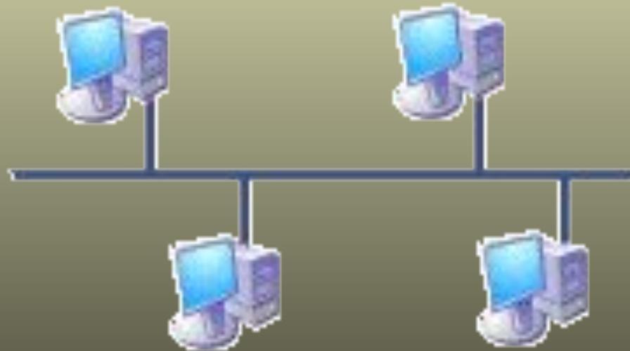
Компьютеры соединены последовательно и подключены к одному кабелю
