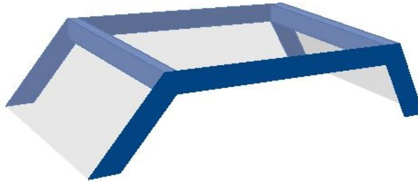
Козырек изготавливается из стекла или прозрачного пластика, который крепится на металлический каркас синего цвета согласно схеме.
