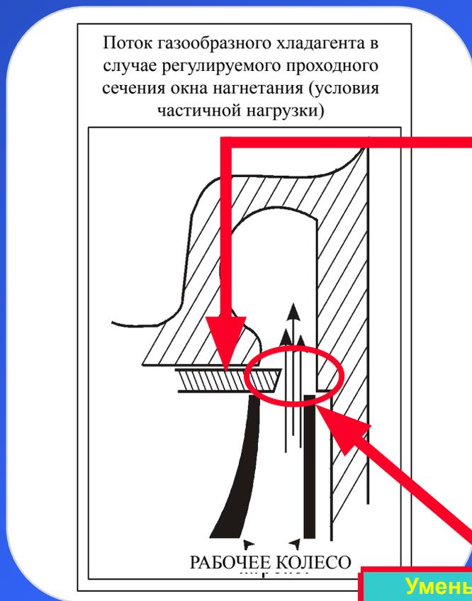
Уменьшение проходного сечения окна нагнетания по мере снижения нагрузки позволяет поддерживать скорость потока хладагента на постоянном уровне, тем самым, предотвращая помпаж компрессора
