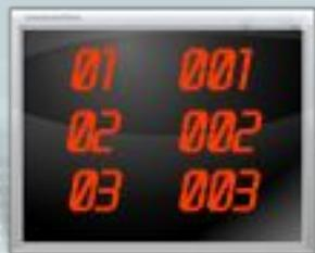
Светодиодное табло, подключаемое по интерфейсу RS485 к серверу СУО, данные на который выводит программный модуль «Сервер СУО».
