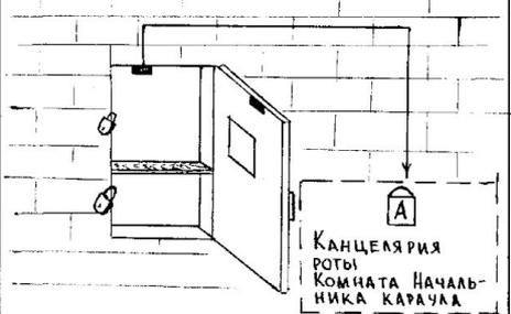
В отдельно дислоцированных подразделениях двери КХО оборудовать сигнализацией типа "Алмаз" или "Трепанг" с выводом ее в канцелярию роты и к начальнику караула по охране объекта.
