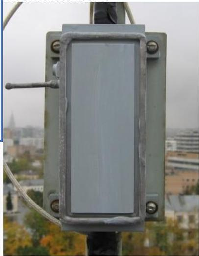
Малошумящий усилитель (МШУ) предназначен для усиления и предварительной фильтрации сигналов НКА. Устанавливается на крыше непосредственно под антенной.
