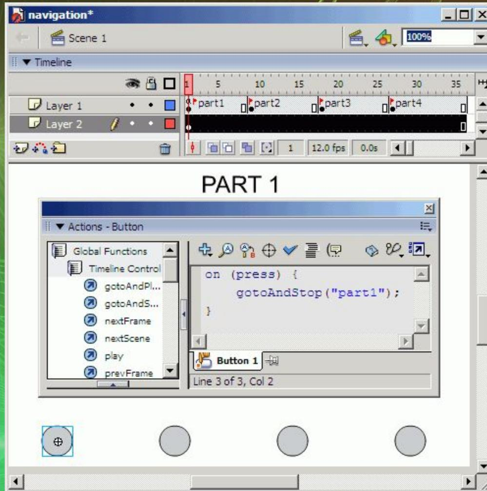
Данный ролик состоит из двух слоев. Первый слой разделен на четыре части, которые содержатся в четырех кадрах, второй включает один ключевой кадр.
