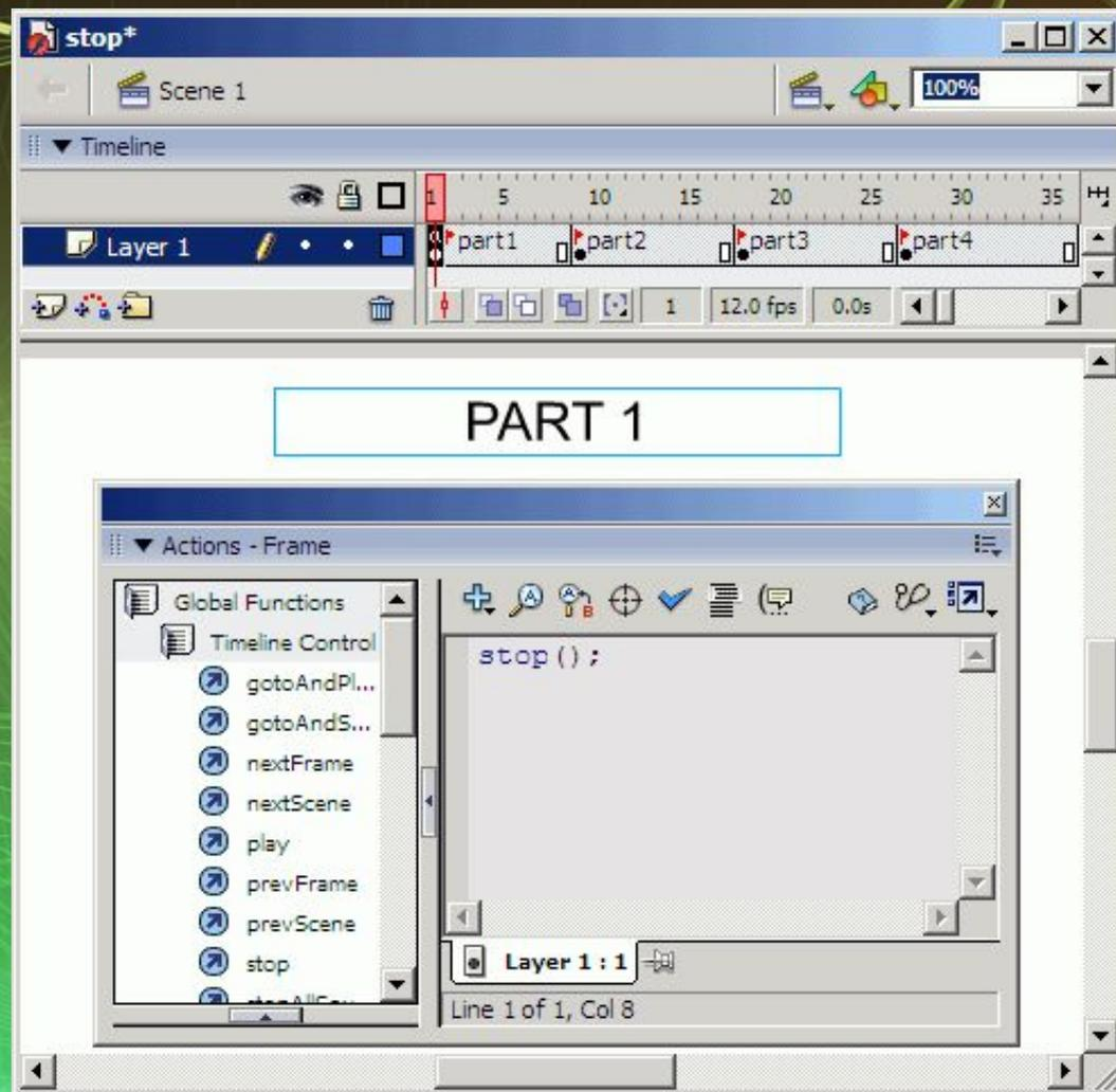
Ролик показанный на этом рисунке состоит из четырех кадров, каждому из которых соответствует метка на временной шкале и текст на рабочем поле. В первый кадр включен небольшой сценарий с командой `stop()`. Воспроизведение ролика начинается и заканчивается в кадре 1.
