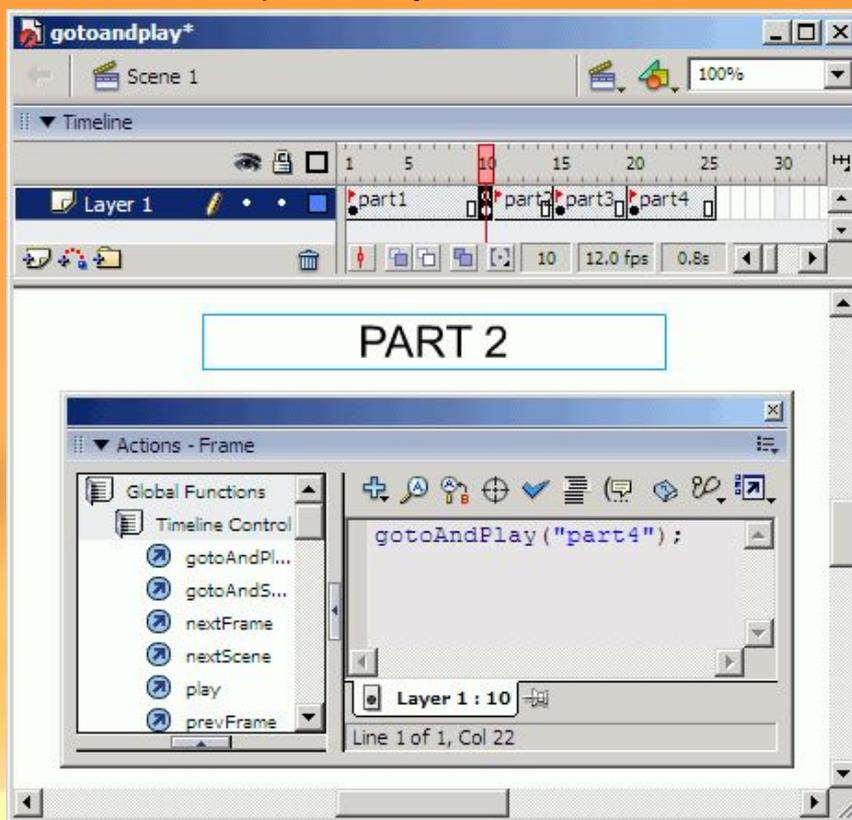
Это единственный код ActionScript в ролике. При воспроизведении ролик начинается с ключевого кадра "part 1" и на экране появится текст "PART 1". Затем ролик будет двигаться по временной шкале до ключевого кадра "part2", где находится код ActionScript. По команде Flash перейдет к ключевому кадру "part4". При этом текст "PART 2" не успеет появиться на экране. Ролик будет находиться в кадре "part4", на экране окажется текст "PART 4".
