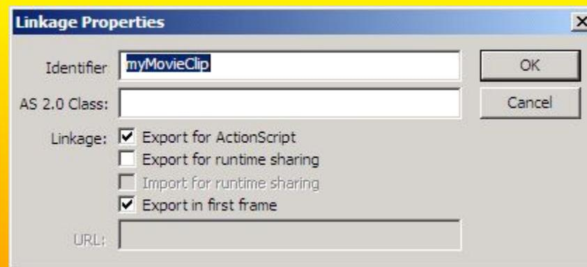
Диалоговое окно Symbol Linkage Properties позволяет включать клип в swf-файл, даже если он не используется на рабочем поле
