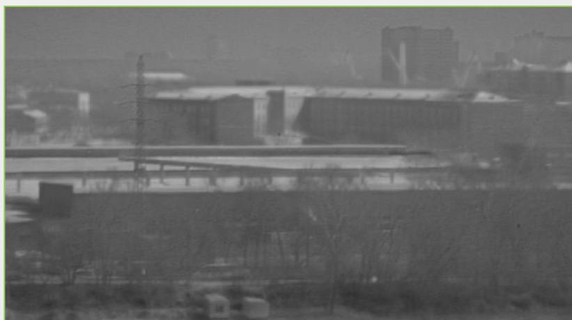
Комплексирование с разделением НЧ и ВЧ составляющих и анализом информативности (дисперсия в окне)
