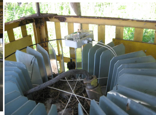
Обмотка РИТЭГа оптоволоконном
