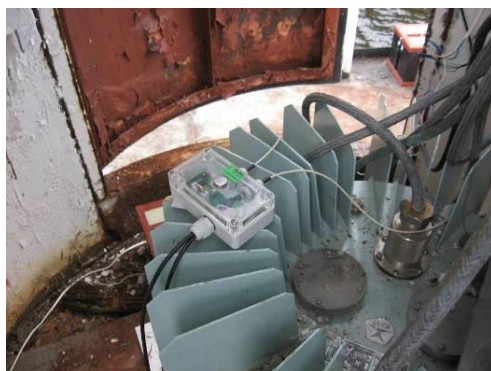
Основной извещатель контроля состояния оптической печати и датчика удара/наклона
