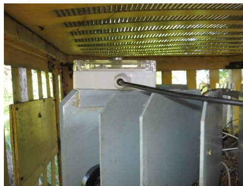
Извещатель акселерометра и оптопечати
